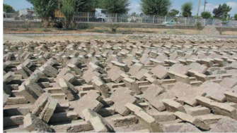
Kalıplarından çıkarılan kerpicing çapraz dizilimle tüm yüzeylerinin kurutulması
